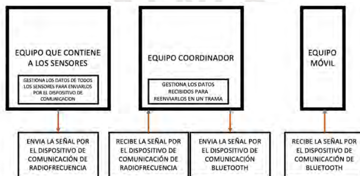
Figura 7. Distribución en bloques de los 3 equipos que serán parte del sistema de registro de datos de cultivo.
