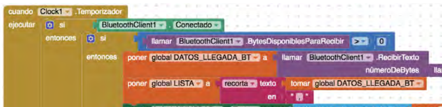
Figura 52. Bloques para comprobar la disponibilidad del módulo bluetooth
