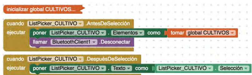
Figura 53. Bloques que permiten generar una lista de opciones y mostrar el elemento seleccionado en la pantalla.
