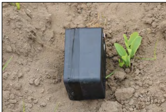
Figura 57. Equipo posicionado de costado apuntando a verificar la temperatura de las hojas del maíz que está en crecimiento.
