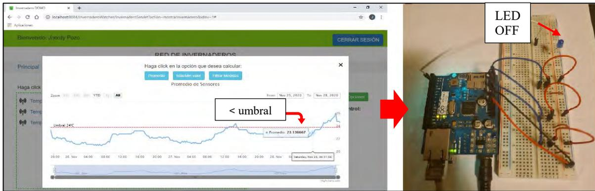
Figura 42 Modo automático LED OFF
