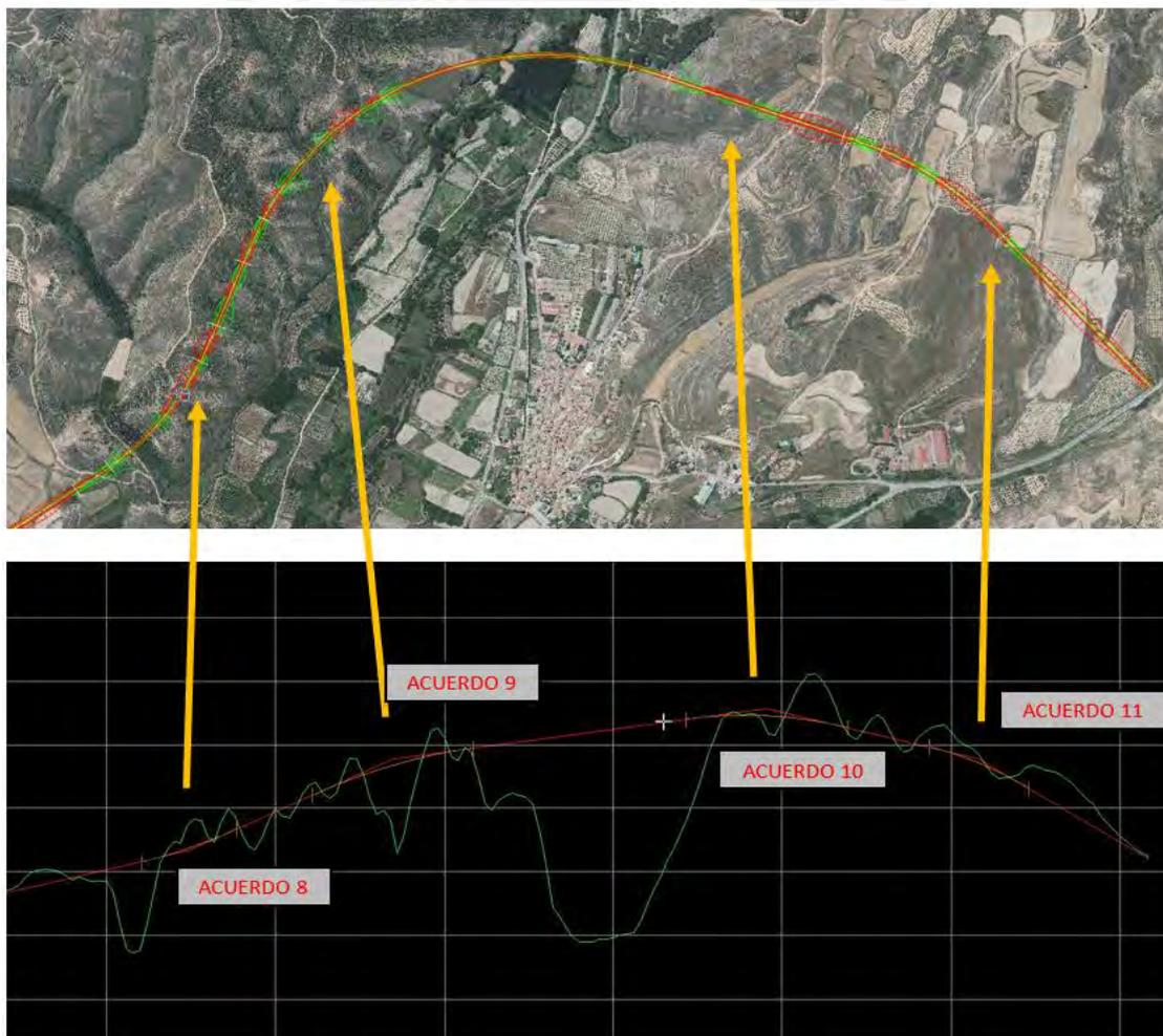
**Figura 4.29 Coordinación Planta-Alzado (Fuente: propia)**
