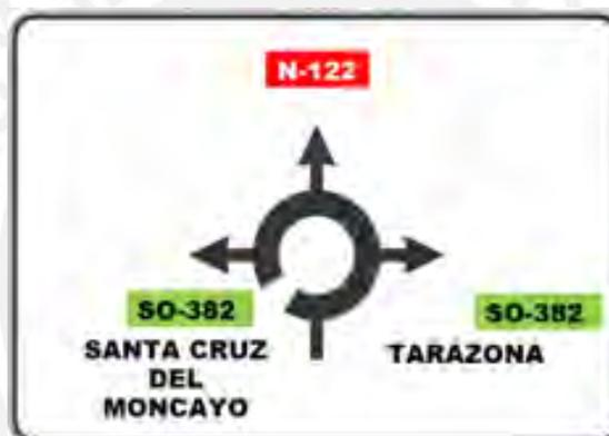
**Figura 4.42 Señal de orientación en intersección (Fuente: propia)**
