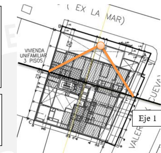
Fig. 17 Primera ubicación de torre grúa.
