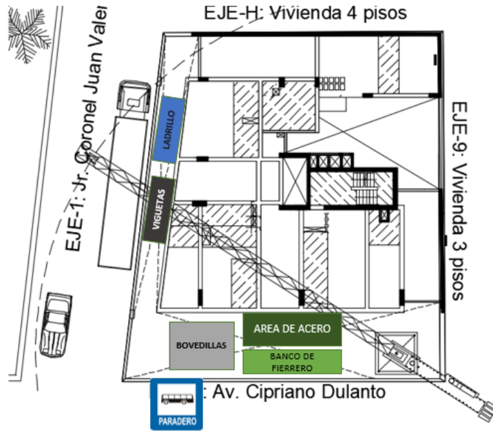
Fig. 51 Distribución de materiales en obra con torre grúa
