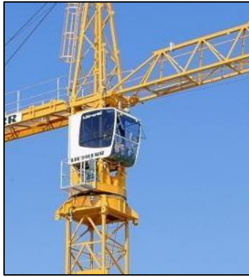
Fig. 28 Cabina de mando torre grúa
