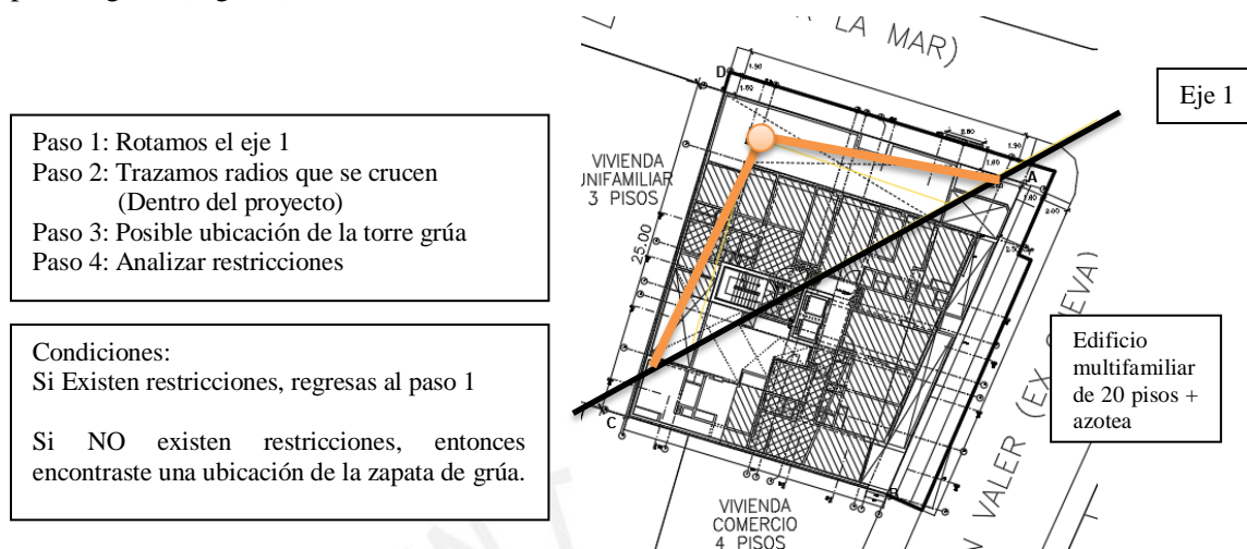
Fig. 19 segunda ubicación de la torre grúa.
