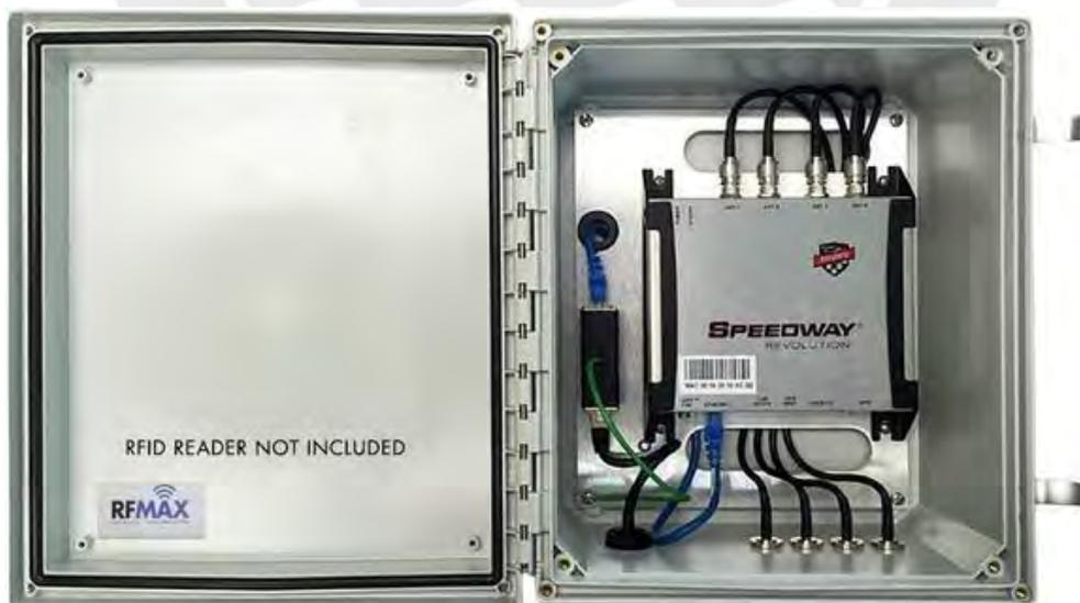
Figura 3-16: Contenedor PCE12106-04W para el lector RFID Impinj r420.
