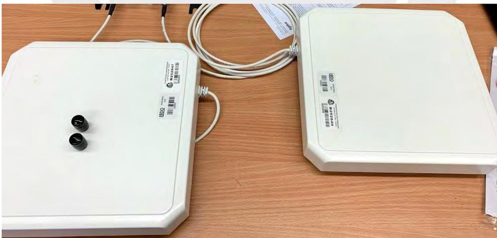
Figura 3-12: Foto de las antenas RFID.
