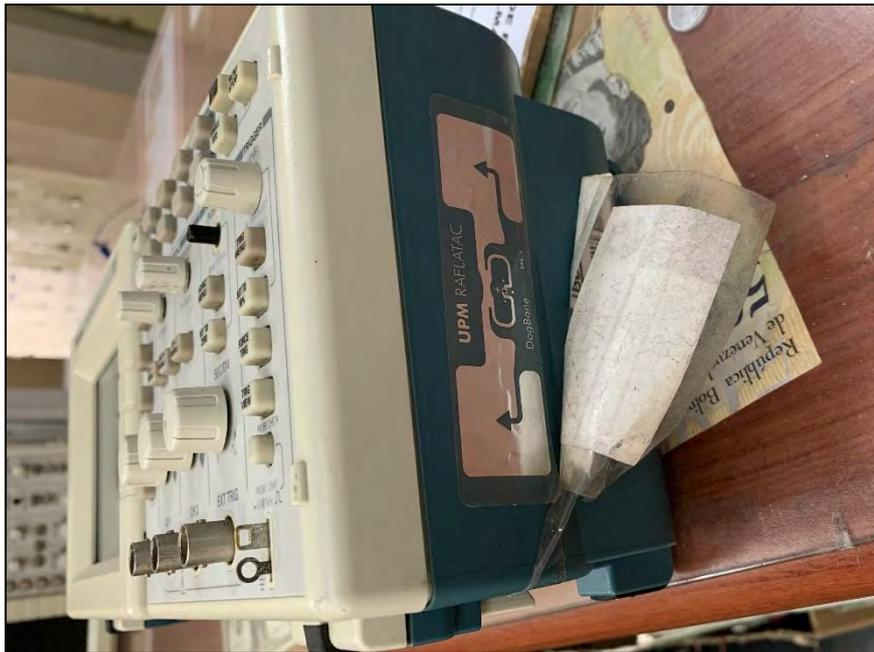
*Figura 4-27: Etiqueta RFID adherida en uno de los lados de uno de los osciloscopios.*
