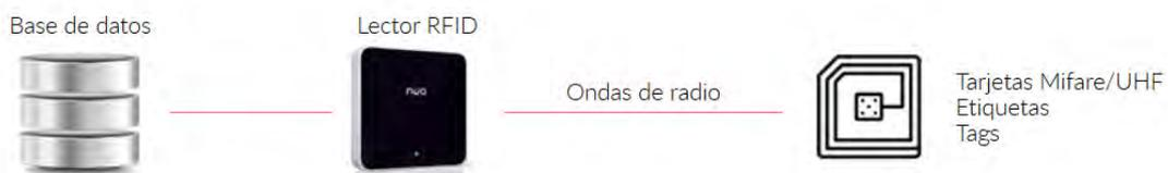
Figura 2-1: Esquema simplificado de operación de la tecnología RFID.
