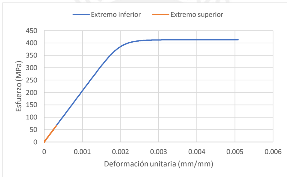
Figura 5.34: Diagramas esfuerzo-deformación de fibras de acero de la columna C4.
