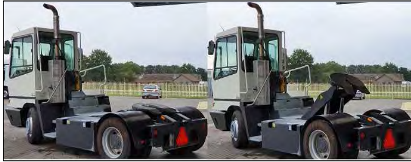
Figura 12 Quinta rueda antes y luego de accionar cilindros hidráulicos
