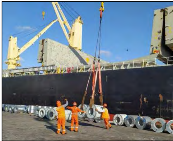
Figura 4 Descarga de bobinas de acero
