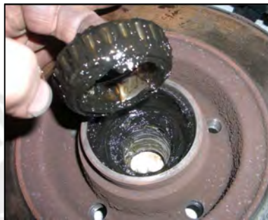
Figura 16 Cambio de rodamientos Tomado de “SlowWorks”, setiembre 2020
