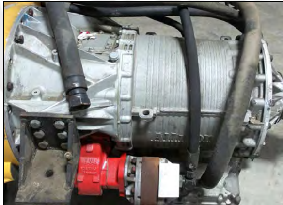
Figura 11 Transmisión y bomba PTO (en rojo) acopladas
