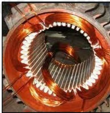
Figura 15 Rebobinado de motor eléctrico
