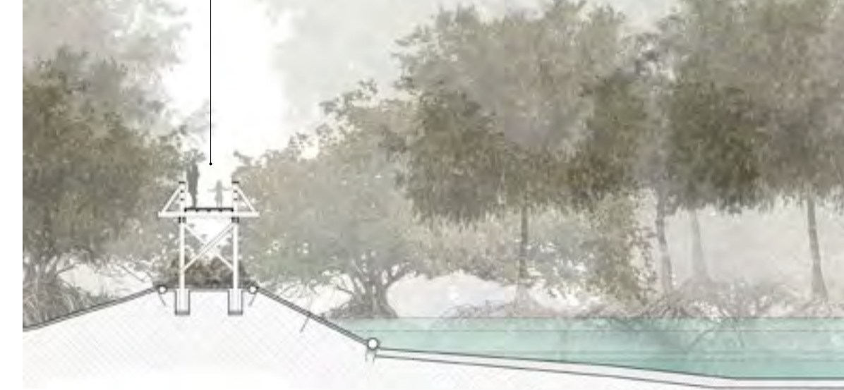
SP2. Pasarela sobre talud de tierra existente reforzado
