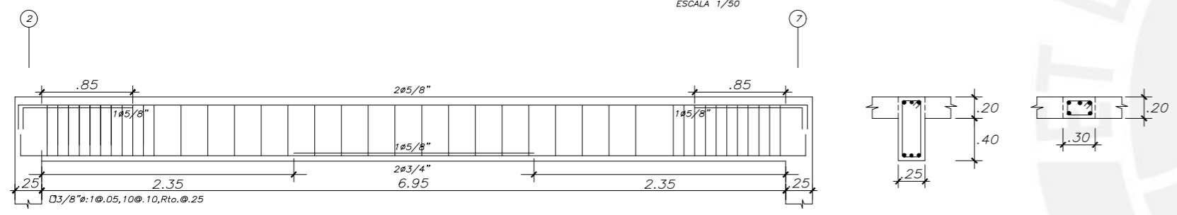
VIGA VA-15 (.25x.60) ESCALA 1/50
