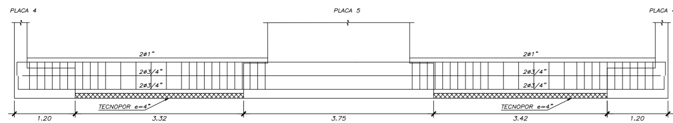
Ø3/8"e:10.05,100.15,Rto.Ø.30 VIGA VC-3(.30x.70) ESCALA 1/75
