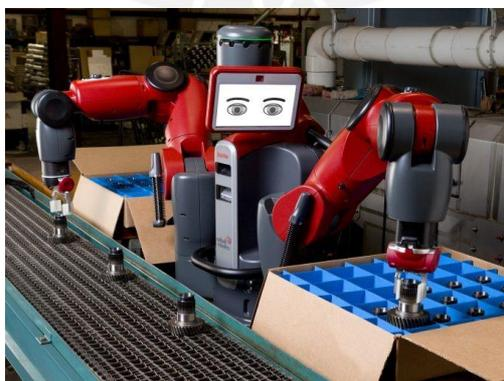
**Figura 1.6** Robot Baxter en manufactura
