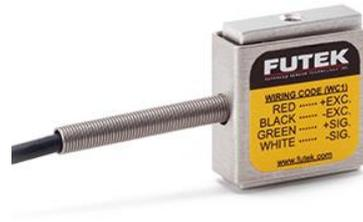
**Figura 3.10** Celda de carga FUTEK
