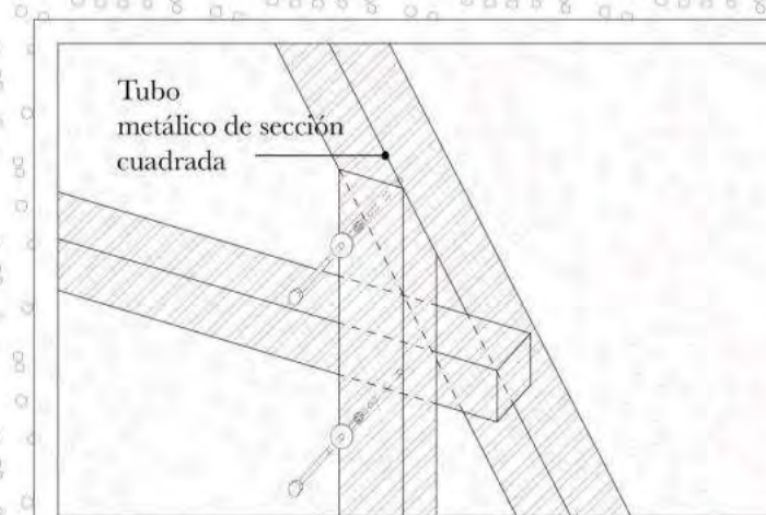
D44 Piezado en estructura de luminaria
