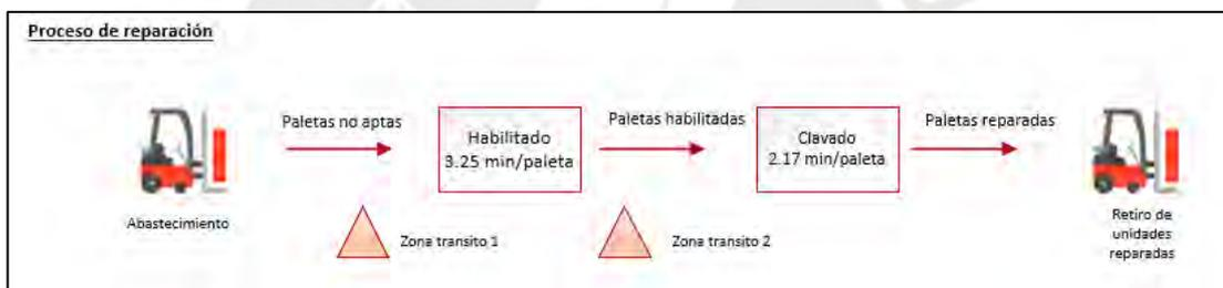
Figura 36: Diagrama de bloques del proceso de reparación
