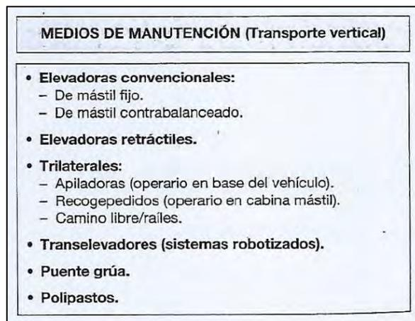
**Figura 14: Medios de manipulación para transporte vertical**
