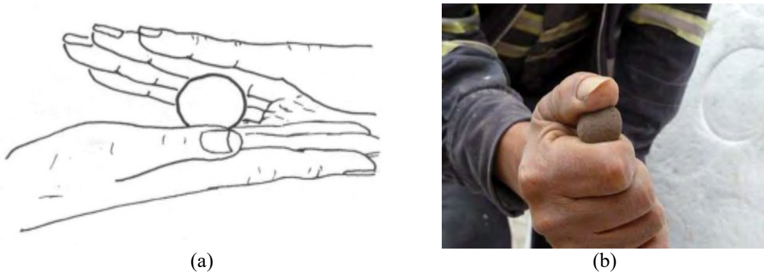
Figura 2.9 Prueba de Resistencia seca: (a) Formación de bolitas de barro (Norma E.080); (b) Ejerciendo presión a la bolita de barro seca (Valle, 2019)
