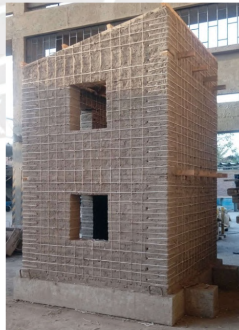
Figura 5.11 Etapa final del reforzamiento con cuerdas sintéticas.
