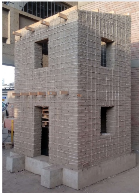
Figura 5.11 Etapa final del reforzamiento con cuerdas sintéticas.
