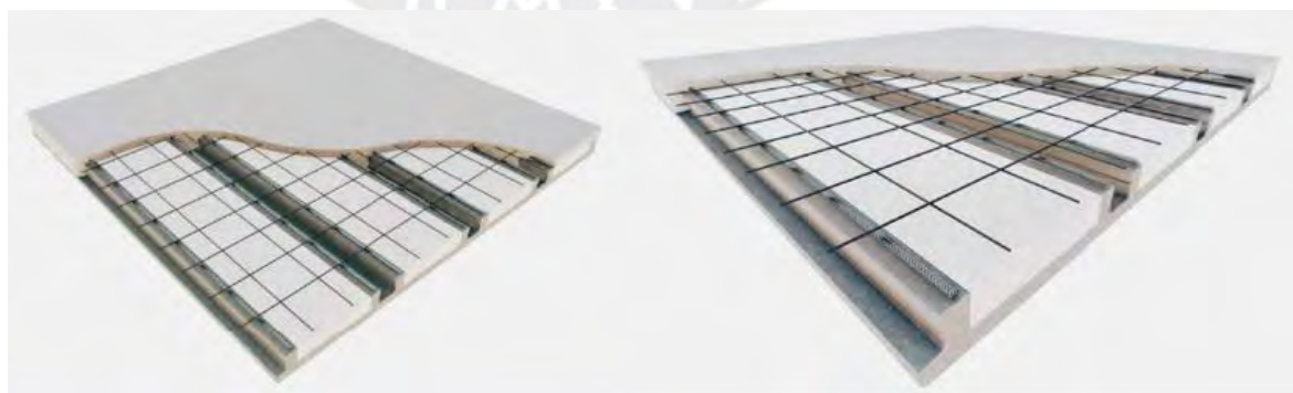
Figura 3-5 Esquema de prelasas con el complemento y posterior vaciado (Concremax, 2019)
