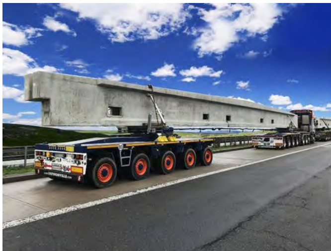
Figura 2-5 Transporte de viga prefabricada
