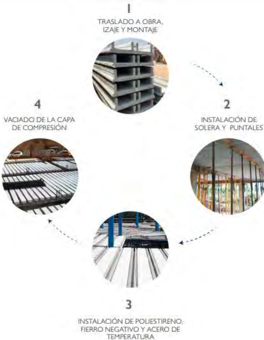
Figura 3-4 Proceso constructivo con prelasas (Concremax, 2019)
