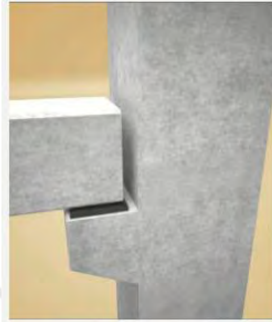
Figura 3-9 Conexión simplemente apoyada en columna-viga (Tecnyconta)
