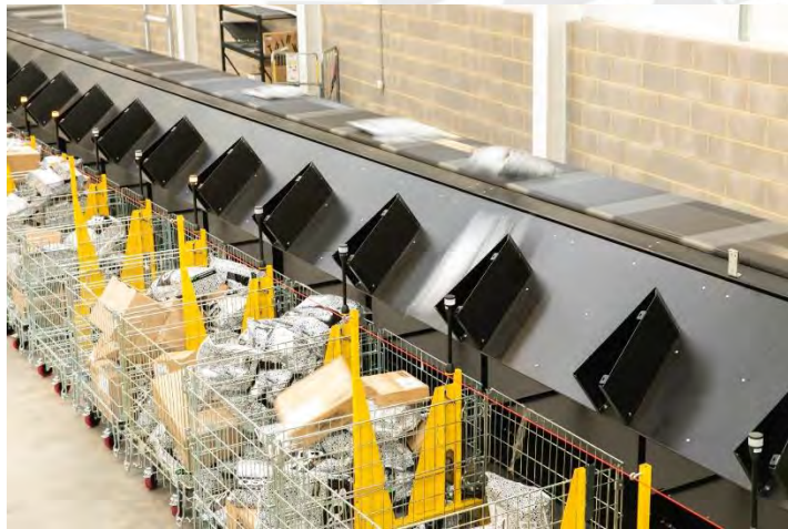
Figura 1.5: Clasificador Crossbelt Sorter Interroll implementado en Skynet
