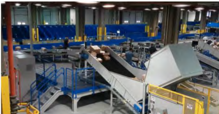
Figura 2.6: Línea automatizada de tratamiento de envíos de Correios de Brasil en Santa Catarina
