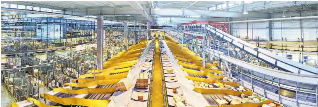
Figura 2.3: Línea automatizada de tratamiento de envíos de Swiss Post
