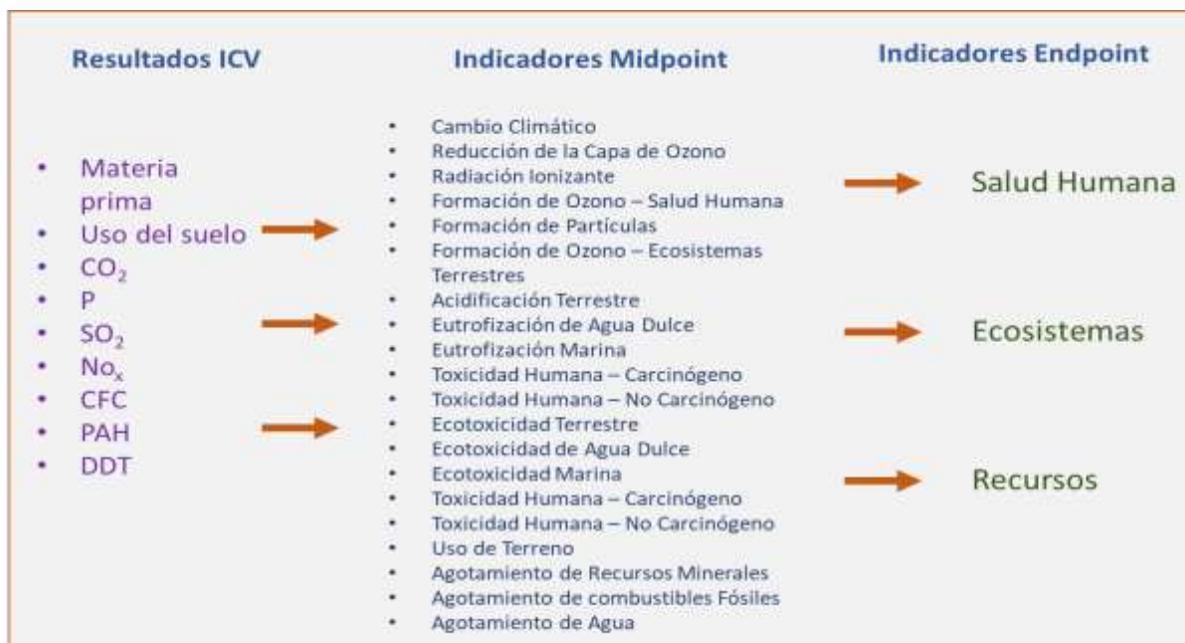
Figura 2.6: Relación entre resultados del ICV, indicadores midpoint y endpoint en la elaboración del AICV mediante la metodología ReCiPe. Fuente: Adaptado de Huijbrets et. al., 2017
