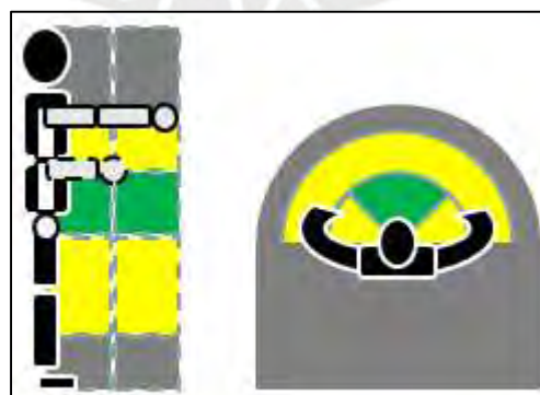
Figura 15 Ilustración del Área del Punto de Uso. Fuente: Manual de teoría Lean Manufacturing de la empresa en estudio.
