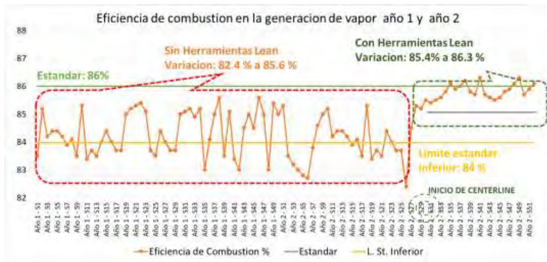
Figura 66 Eficiencia de combustión antes y después de implementación de Centerline Fuente: elaboración propia
