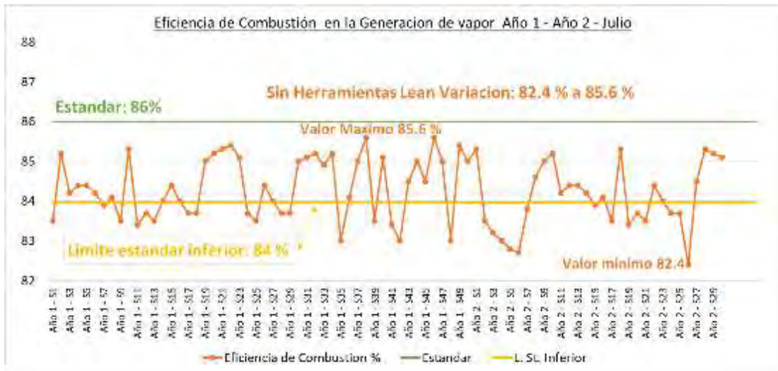
Figura 48 Eficiencias de combustión de caldera Cleaver Fuente: Elaboración propia
