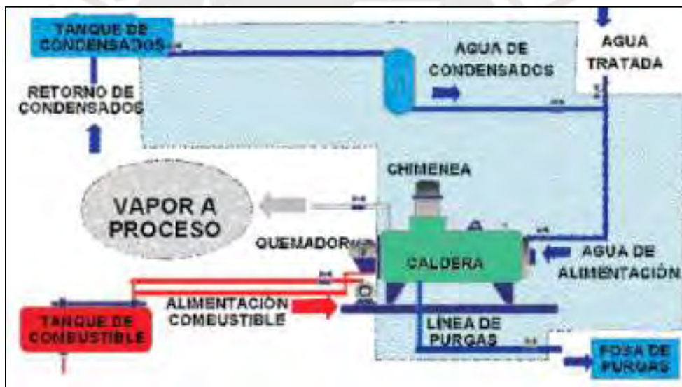
Figura 33 Sistema de Generación y distribución de Vapor
