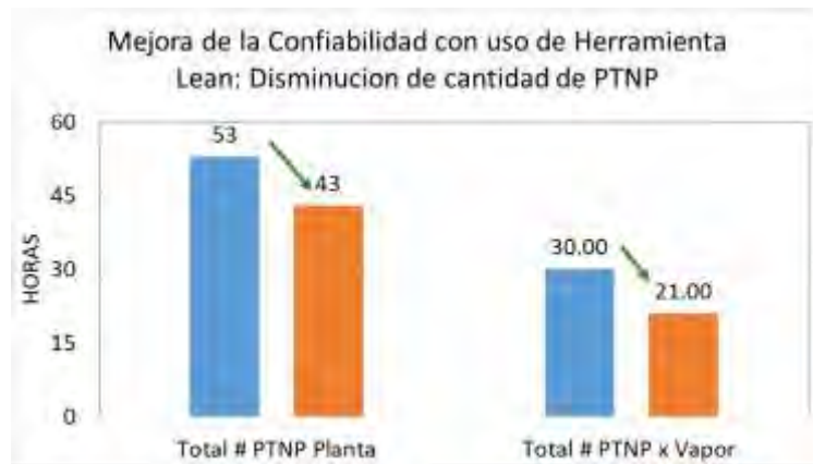
Figura 71 Mejora en números de Paros Técnicos No Programados con la implementación de Lean Fuente: Elaboración Propia.
