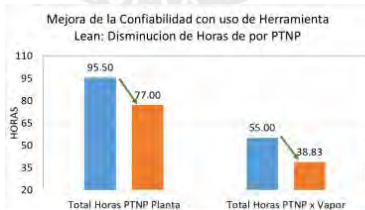
Figura 70 Mejora en horas en los paros técnicos no programados - PTNP con la implementación de Lean Fuente: Elaboración Propia.
