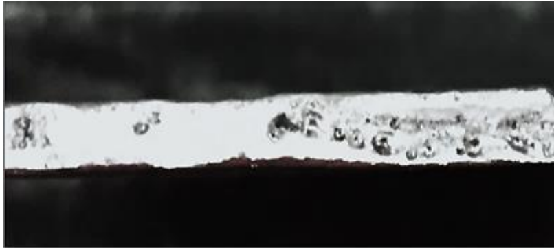
Figura 54.- Porosidad y falta de fusión en la estructura interna de una probeta sin material de aporte
