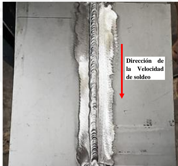
Figura 16.- Cupón óptimo con aporte de calor
