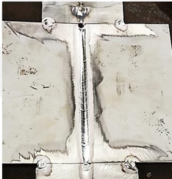
Figura 19.- Cupón soldado sin material de aporte
