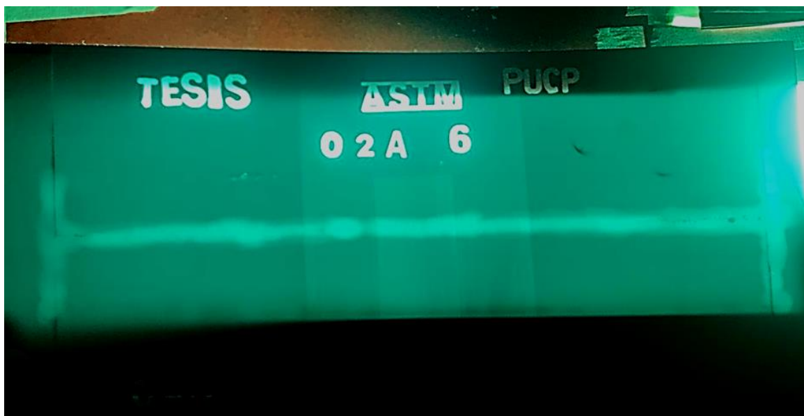
Figura 51.- Radiografía cupón con material de aporte
