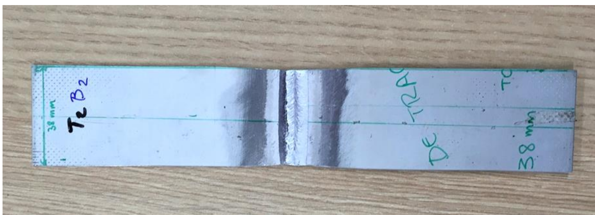
Figura 53.- Rotura de la probeta sin material de aporte
