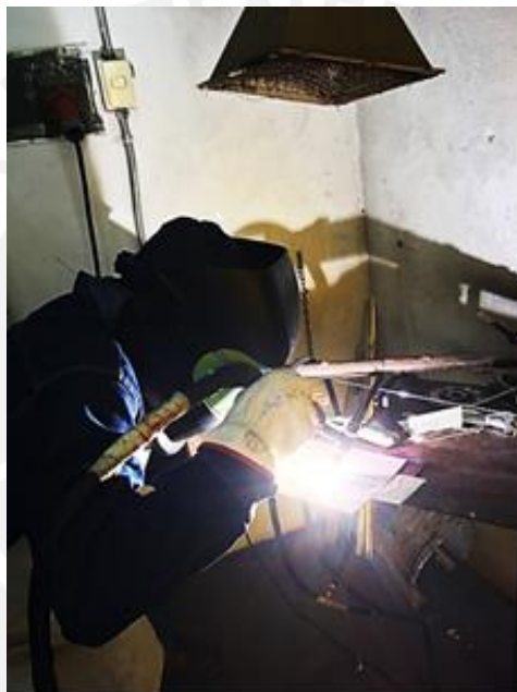
Figura 17.- Soldadura con material de aporte
