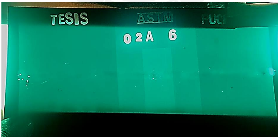
Figura 52.- Radiografía cupón sin material de aporte
