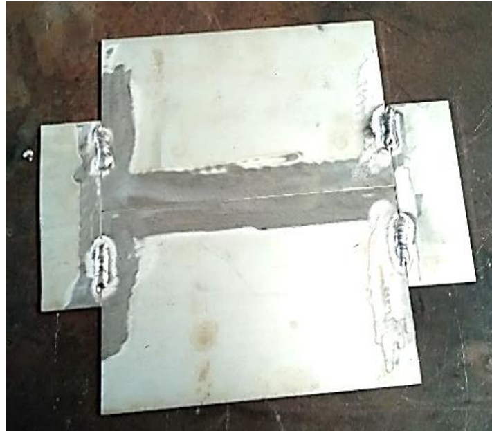
Figura 39.- Cupón apuntalado a tope (sin separación)
