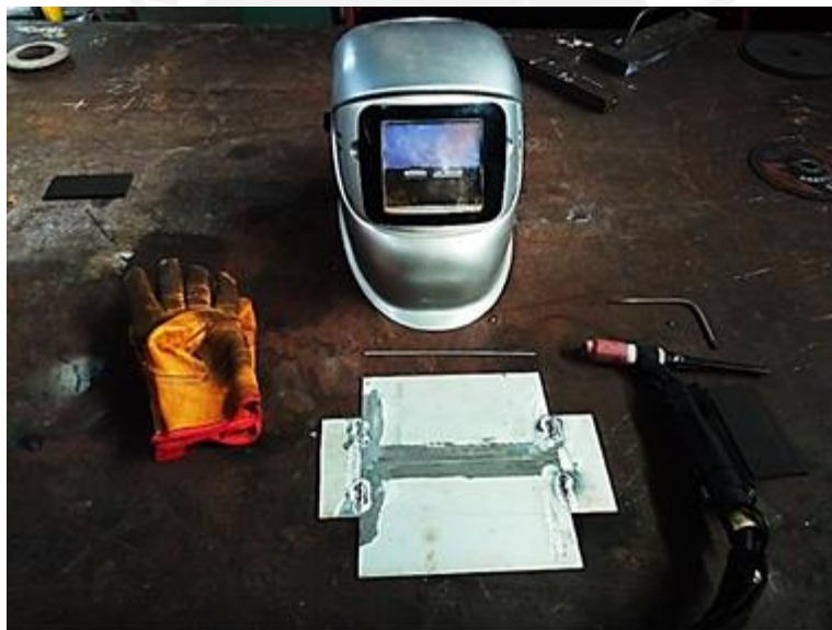
Figura 13.- Apuntalado de los extremos de los cupones
