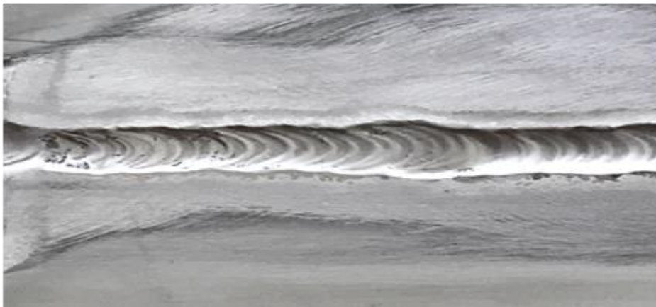
Figura 44.- Porosidades en el cordón con material de aporte
