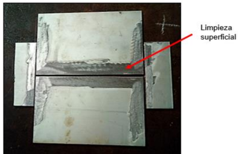
Figura 12.- Limpieza de los bordes antes del soldeo
