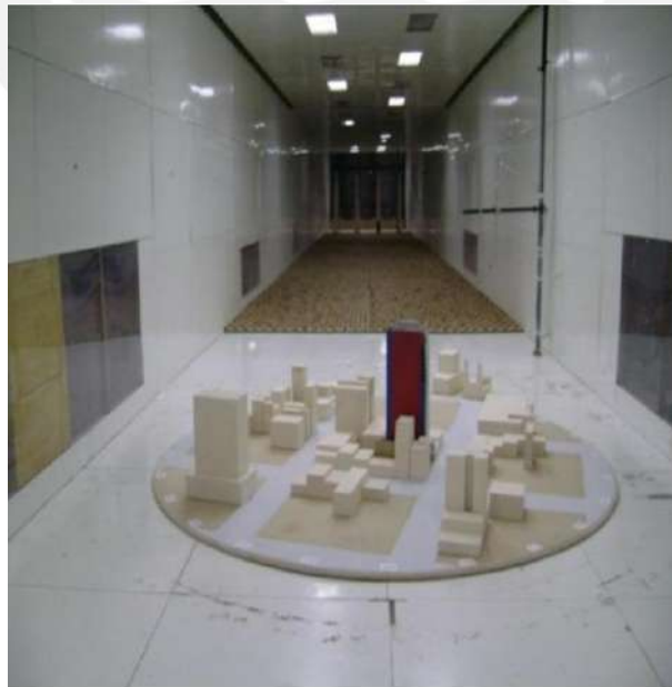
Figura 71: Túnel de viento con aplicación al diseño de edificaciones.
