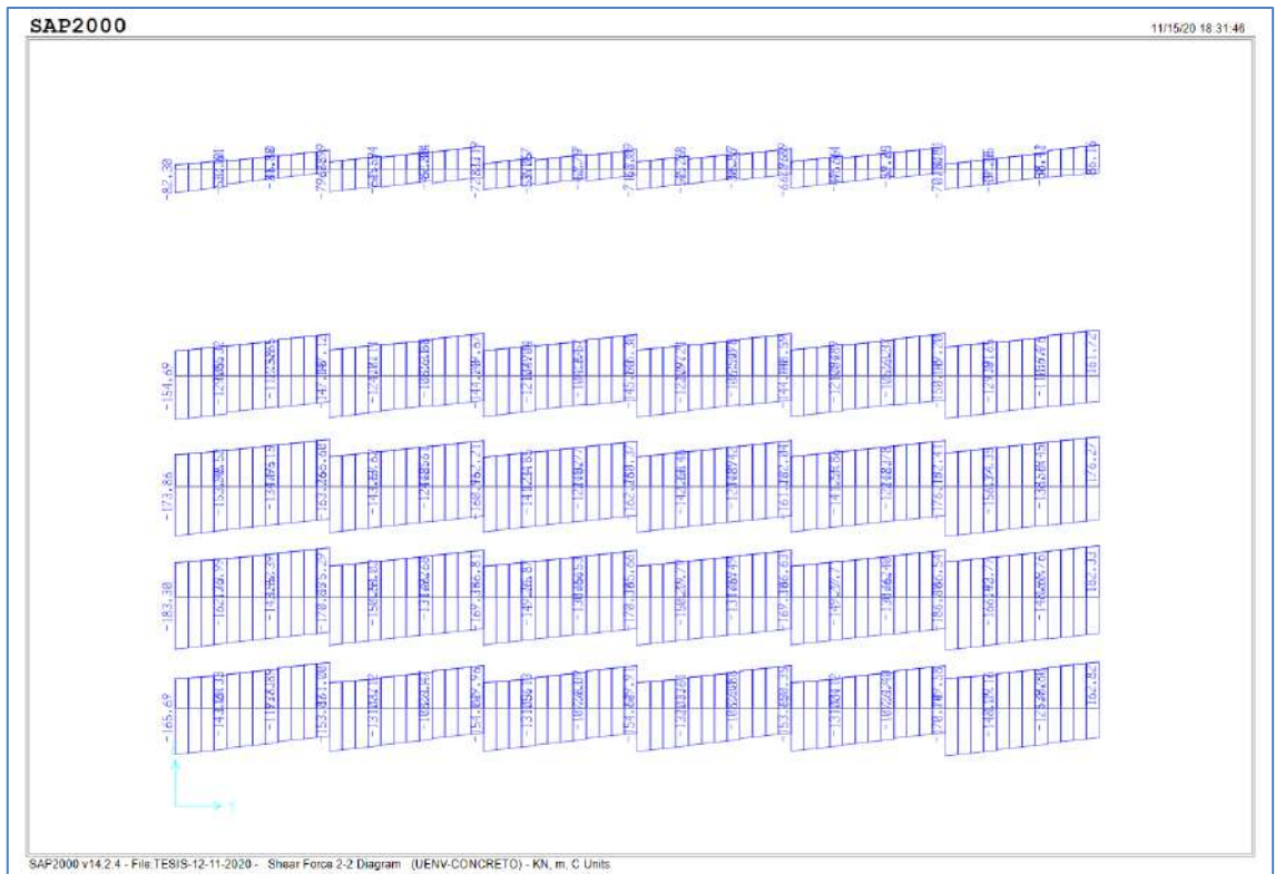
Figura 190 : Fuerzas cortantes en vigas V1.
