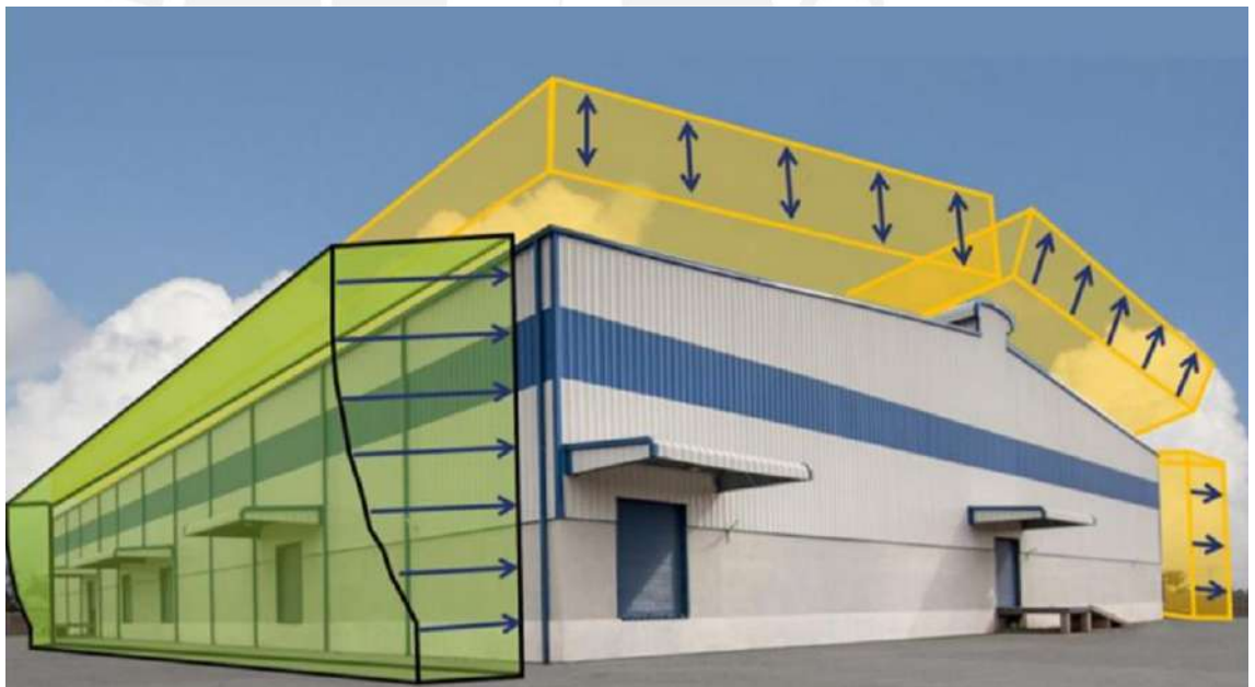
Figura 69. Vista 3d de acción de cargas de viento sobre edificio a dos aguas.
