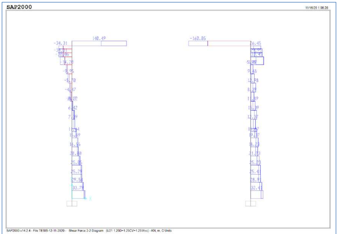
Figura 204 : Fuerzas cortantes en columnas C1A para la combinación 1.25D+1.25CV+1.25Wxx. (Pórtico Central).
