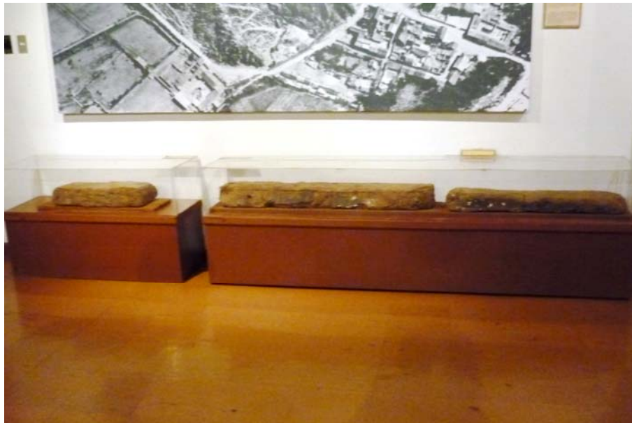
Figura 3.1. De izquierda a derecha adobe Inca de la ciudad del Cusco: siglo XVI con dimensiones 0.50 x 0.15 x 0.10m, siglos XV- XVI con dimensiones 1.10 x 0.15 x 0.10m, siglo XVI con dimensiones 0.85 x 0.15 x 0.10m.
