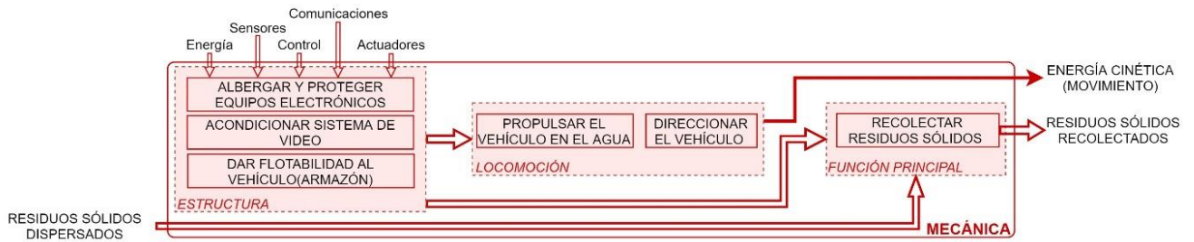
Figura 30. Dominio mecánico del vehículo marino
