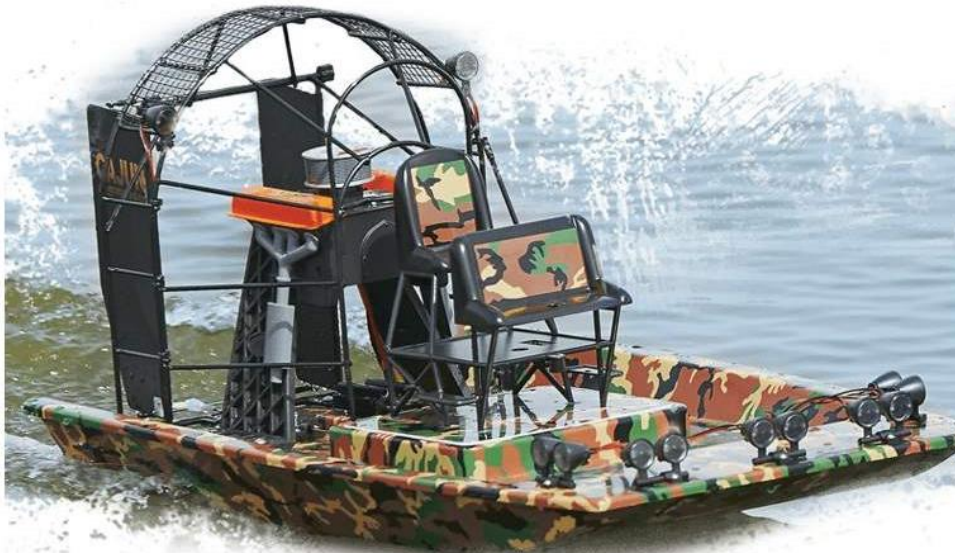
Figura 22. Un hidrodeslizador es propulsado por helice de aviación
