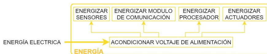
Figura 32. Dominio de energía del vehículo marino
