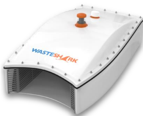
Figura 6. Robot “WasteShark” acumula residuos en su interior
