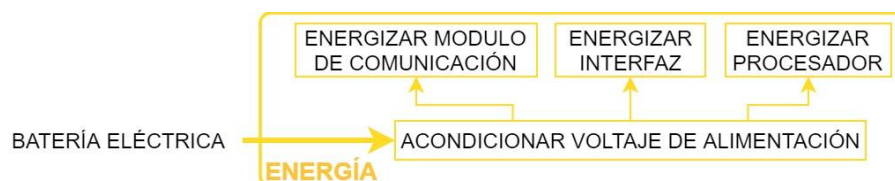
Figura 33. Dominio de energía del mando de control
