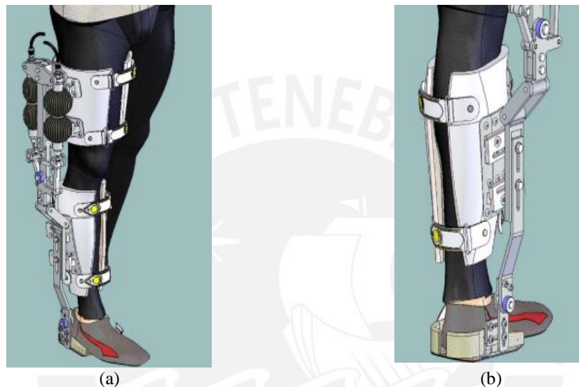
Figura 31. Exoesqueleto de Pieter Beyl. A) Vista completa, b) Vista de armazón de la pierna
