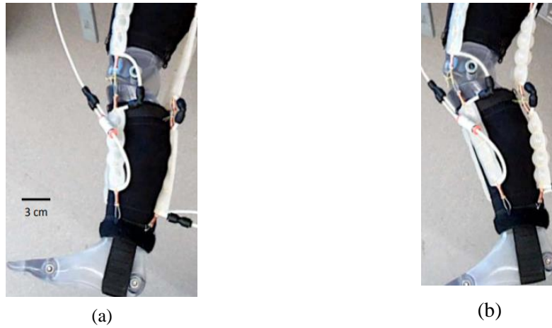
Figura 38. Exoesqueleto de Wehner. (a) Actuadores McKibben, (b) Disposición del dispositivo.
