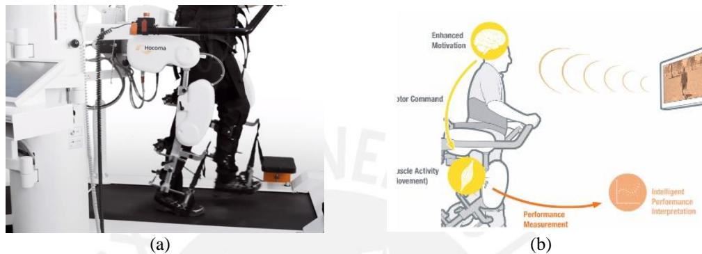
Figura 33. LokoMat. a) Funcionamiento de dispositivo, b) Esquema de interacción de usuario
