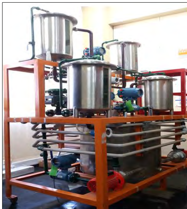
Figura 1. Planta de 4 tanques acoplados [1]
