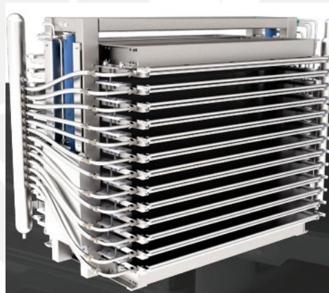
Figura 2.6 Congelador de placas horizontal.
