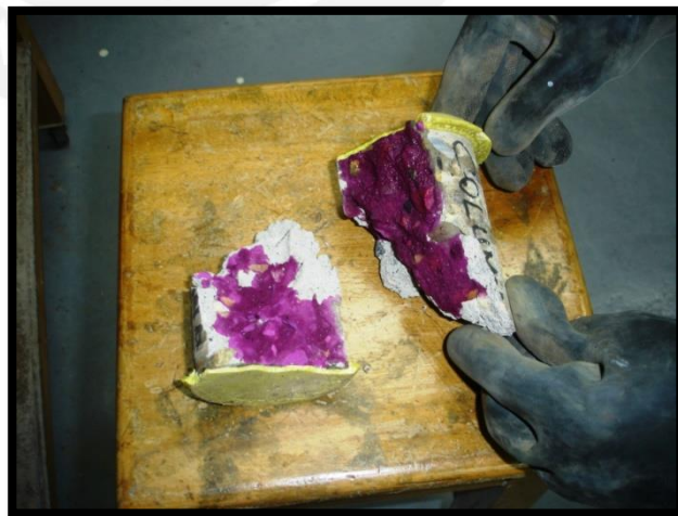
Ilustración 8: Carbonatación del concreto
