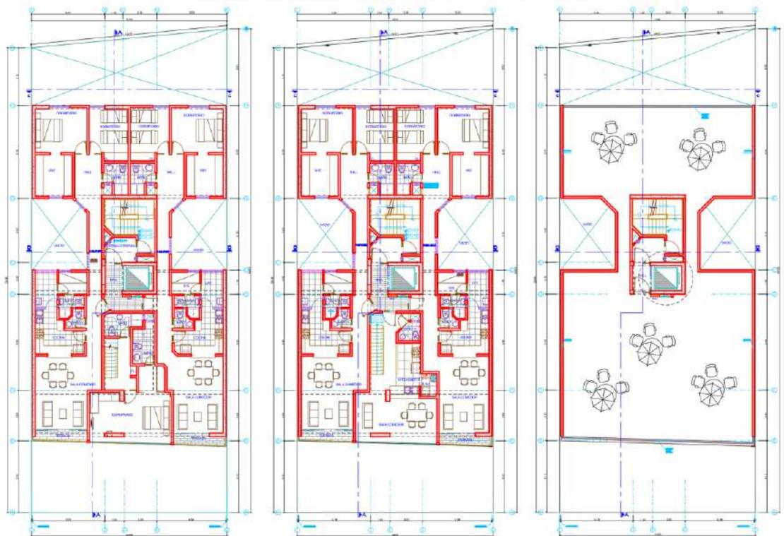
**Figura 1.3.2** Plantas de arq. de Pisos Pares, Pisos Impares, y Azotea (Izq. a Dcha.)
