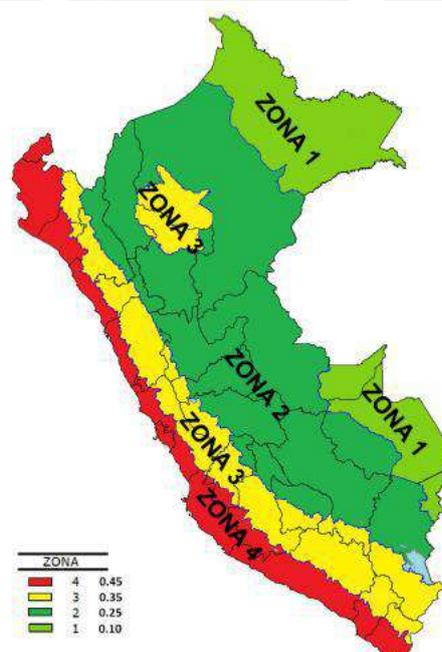
Figura 4.2.1 Zonas sísmicas según la Norma E.030
