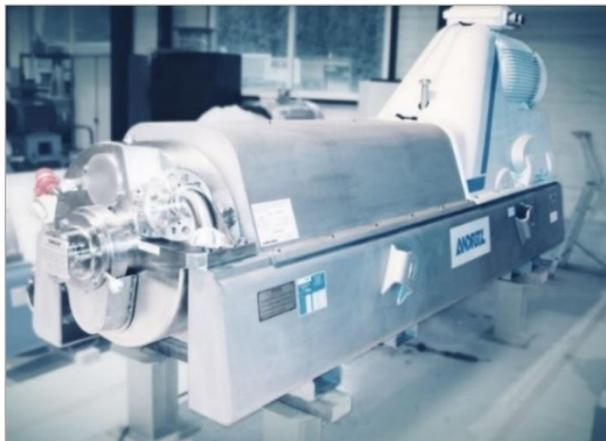
Figura 14. Centrífuga decantadora F7000
