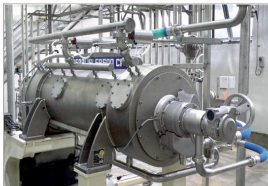
Figura 13. Decanter centrífugo
