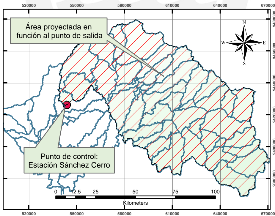
Figura 4.6 Estación Sánchez Cerro como punto de control del proyecto HMS
