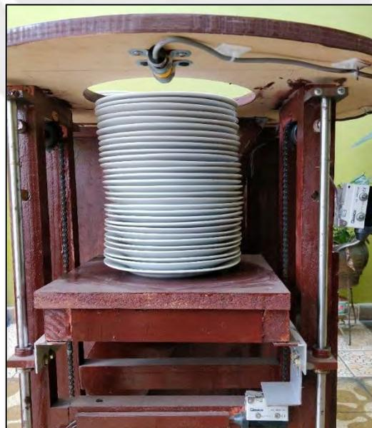
*Figura 3.3.* Apilamiento de platos de entrada. Fuente: elaboración propia.
