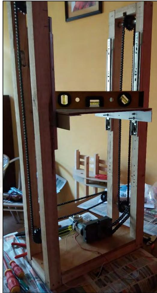
*Figura A11. (Izquierda) Rieles de cajón y ángulo de aluminio. (Derecha) Primera versión de estructura de apilamiento. Fuente: elaboración propia.*
