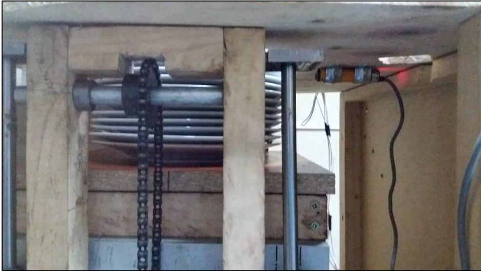
*Figura 4.16.* Detección de platos de segundo. Fuente: elaboración propia.
