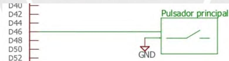
Figura 3.39. Circuito esquemático del botón que inicia el juego aleatorio. El pin 46 se configura en el programa con resistencia interna de pull-up. Fuente: elaboración propia.
