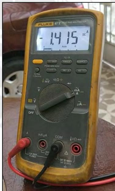
Figura 4.23. Corriente al ascender 30 platos de segundo. Fuente: elaboración propia.
