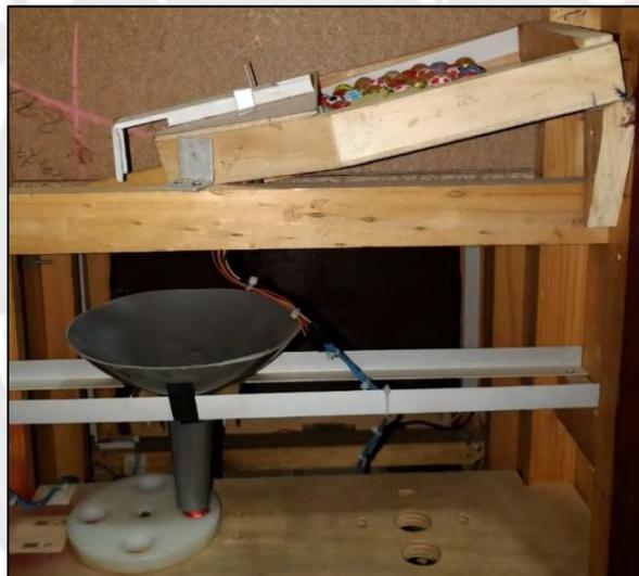
*Figura 3.20.* Embudo y disco. Fuente: elaboración propia.
