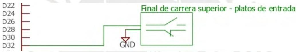
Figura 3.35. Circuito esquemático del final de carrera superior, platos de entrada. El pin 32 se configura en el programa con resistencia interna de pull-up. Fuente: elaboración propia.
