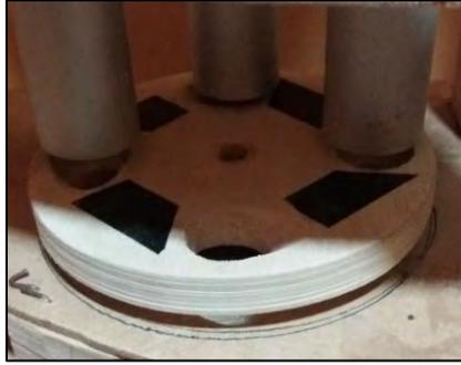
*Figura A32.* Plataforma adherida al eje del motor. Fuente: elaboración propia.
