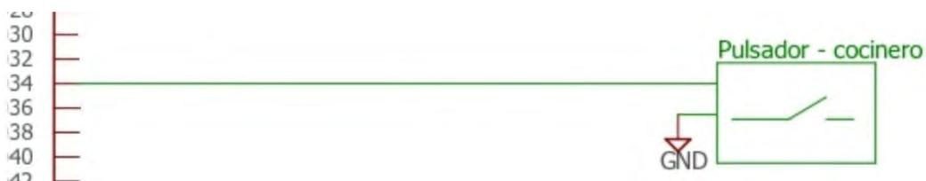
Figura 3.40. Circuito esquemático del botón orientado al cocinero. El pin 34 se configura con resistencia interna de pull-up. Fuente: elaboración propia.
