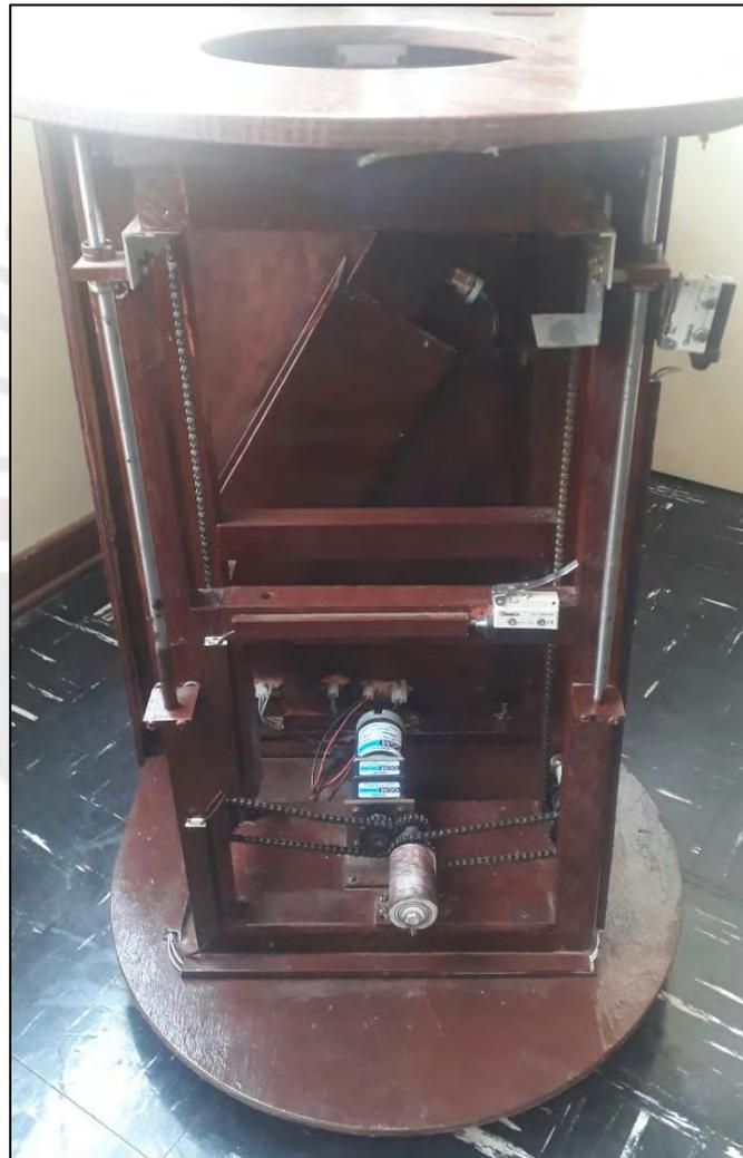
*Figura 3.11. Mecanismo de apilamiento de platos. Fuente: elaboración propia.*
