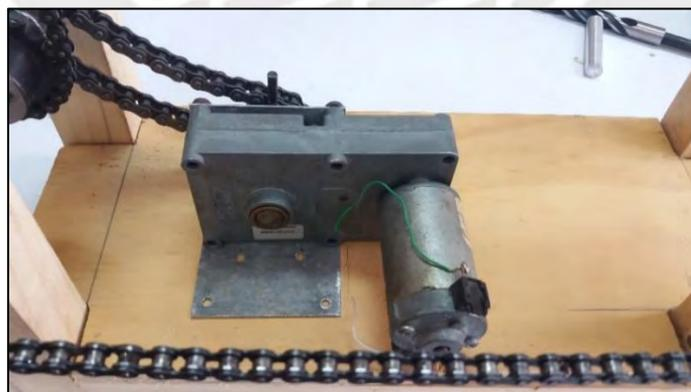
*Figura A10.* Motor de corriente continua con caja reductora. Merkle-Korff S5002H. Fuente: elaboración propia.
