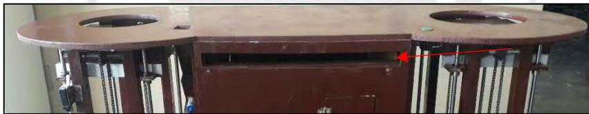
*Figura 3.5.* Orificio para depósito de bandejas. Fuente: elaboración propia.
