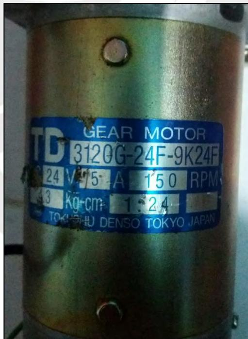
Figura A14. Datos de placa del motor. Fuente: elaboración propia.
