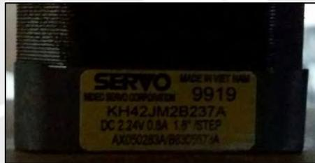
*Figura 3.23.* Motor paso a paso KH42JM2B237A. Fuente: elaboración propia.
