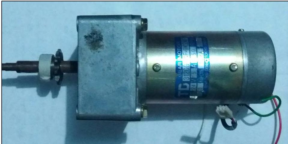
Figura A13. Motor de corriente continua 3120G-24F-9K24F, Tokushu Denso.
