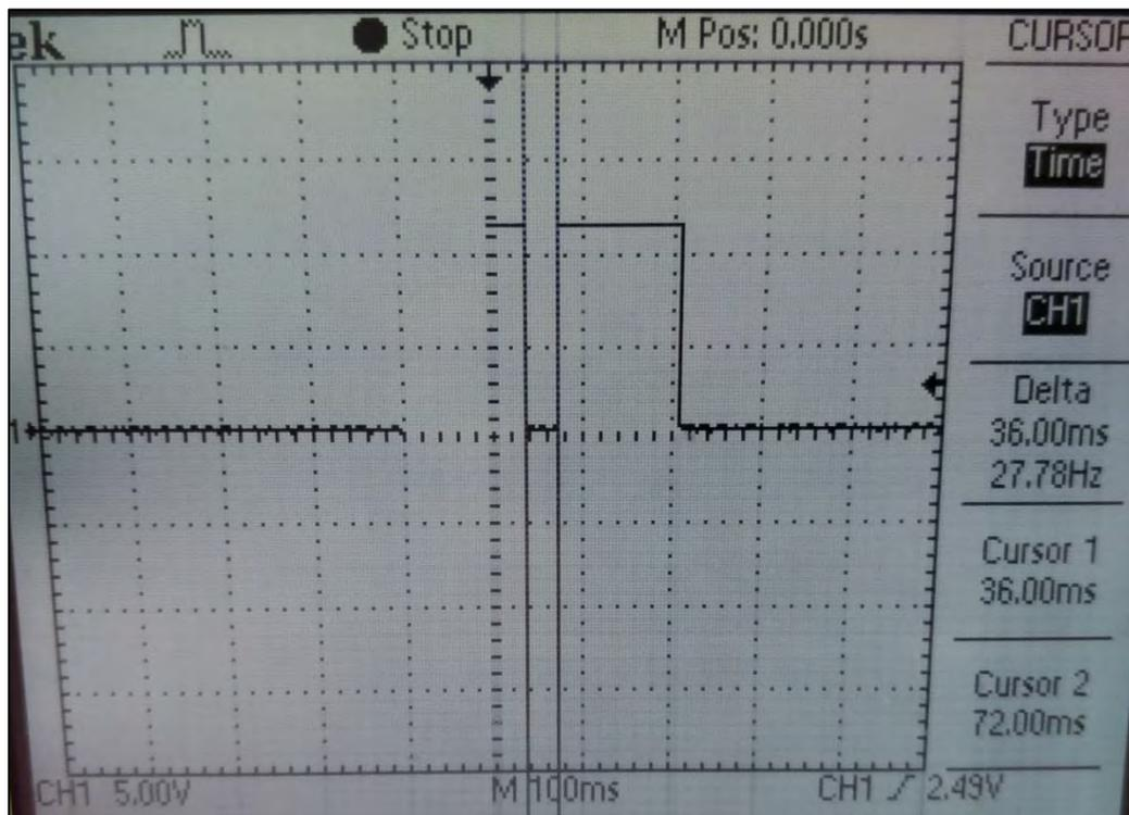
Figura 4.10. Detección de 2 pulsos con cuchara pequeña. Fuente: elaboración propia.
