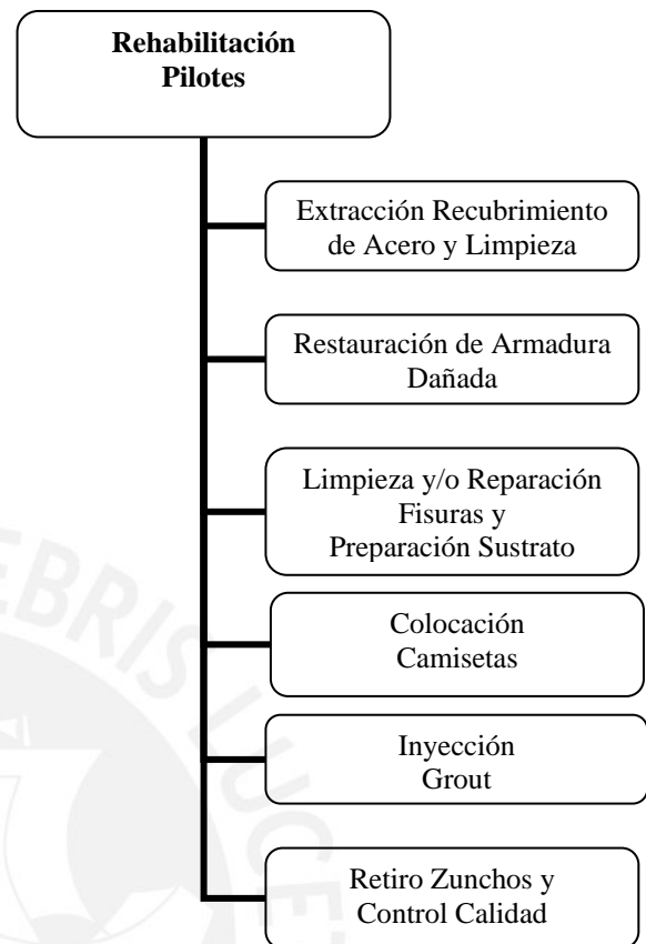
Fig. 5.2.- Actividades generales en la Rehabilitación de los pilotes
