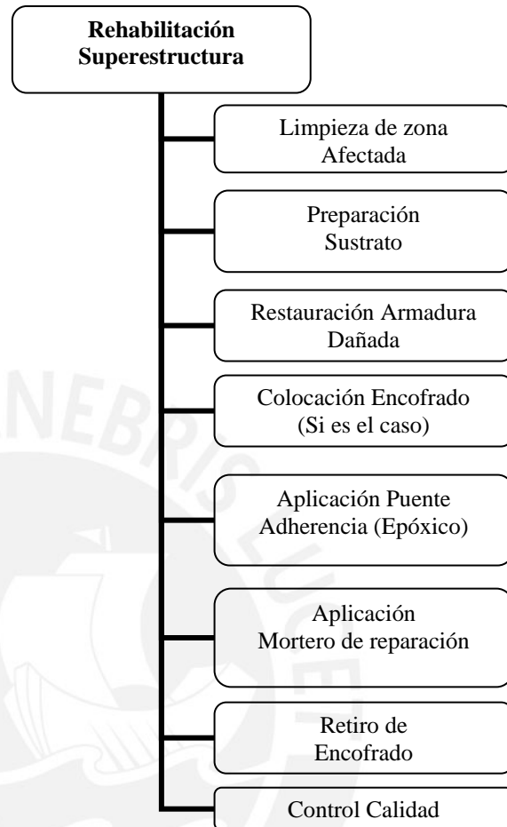
Fig. 5.3.- Actividades generales en la Rehabilitación de la superestructura.
