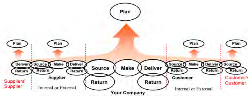
Figura 5: El modelo SCOR está organizado alrededor de cinco Procesos Primarios de Gestión
