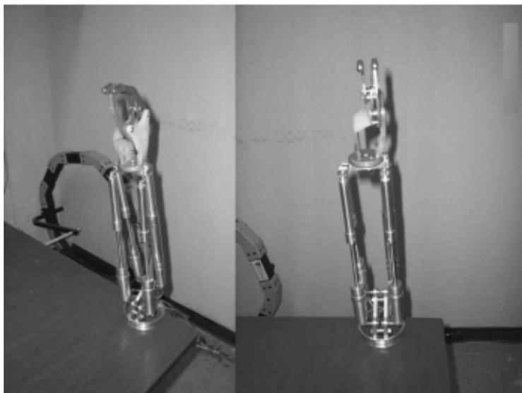
Fig. 2.11. Prototipo de mecanismo paralelo para aplicación de prótesis [Mendoza, 2014]
