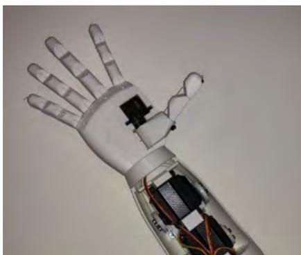
Fig. 2.13 Prótesis con micro servos que permiten el movimiento de sus dedos [Tapia, 2017]
