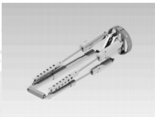
Fig. 2.12. Mecanismo en paralelo con actuadores lineales [Mendoza, 2014]
