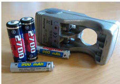
Fig. 2.20. Batería recargables NiMh<sup>12</sup>
