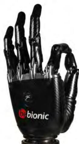
Fig. 2.23 Prótesis de mano Bebionic realizada en fibra de carbono
