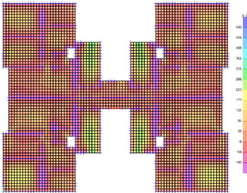
Figura 5.5: Diagrama de momento flector para carga última de diseño en la dirección X (ton-m)
