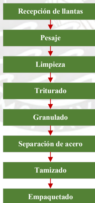
Figura 1: Diagrama de bloques del proceso de reciclaje de neumáticos
