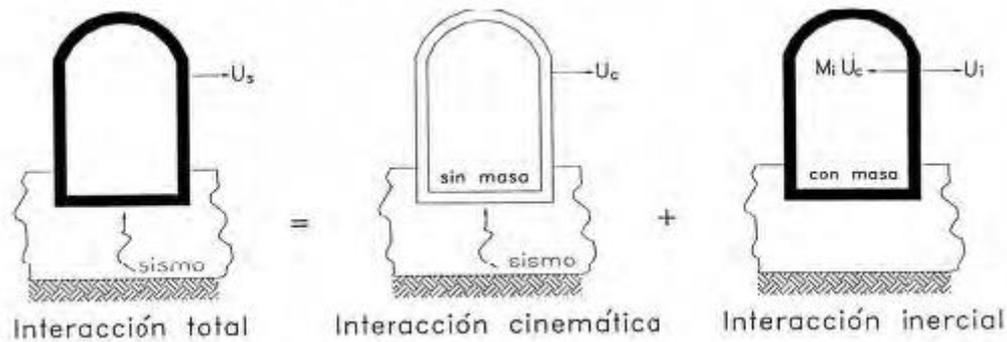
Figura 3.4 - Superposición del fenómeno de interacción suelo – estructura (Avilés, 1999).
