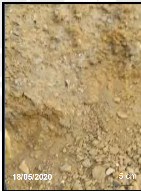
Ilustración 9: Muestra 3, referido a zona de materiales combinados entre relave y residuos sólidos de la población asentada
