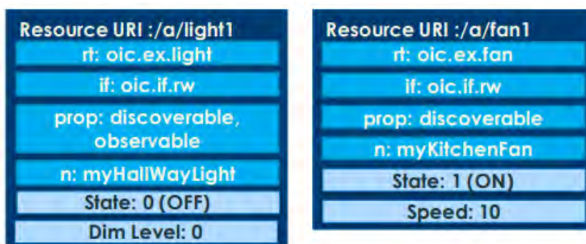
Figura 2-4 Ejemplo del modelado de un foco y ventilador por OCF
