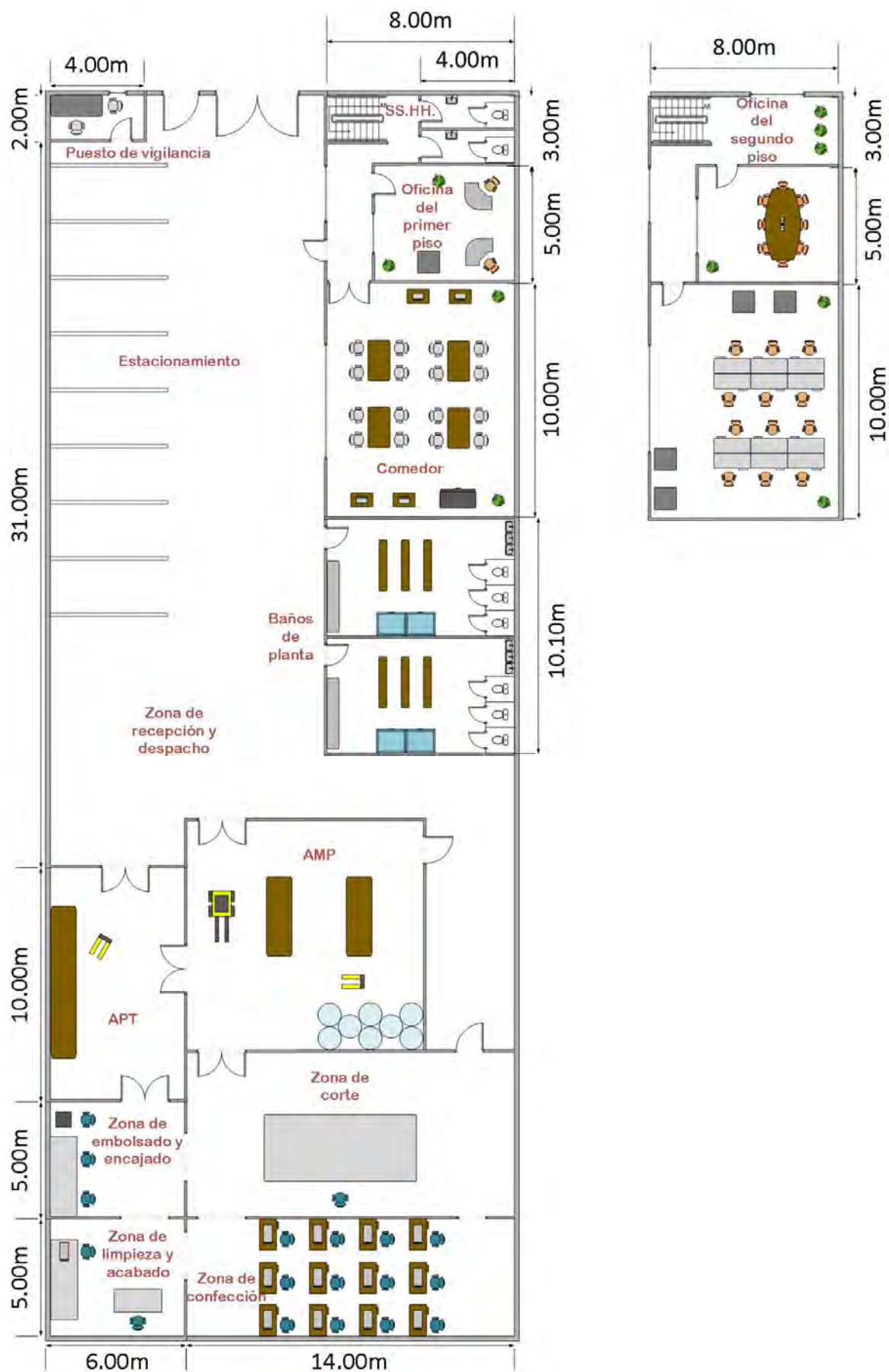
Figura 21: Primer y segundo piso de planta, escala 1:100
