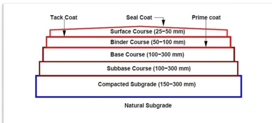
Figura 5. Sección típica de un pavimento flexible
