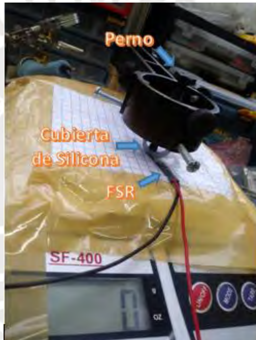
Figura B1. Montaje para calibración del FSR
