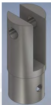
Figura 4.16 Horquilla exterior del Soporte del muslo
