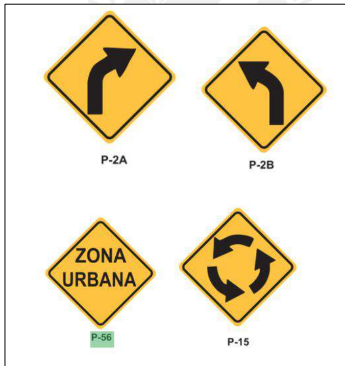
Figura 51: Algunas señales preventivas recomendadas para el proyecto. Fuente: Manual de dispositivos de control de tránsito automotor para calles y carreteras, 2016.
