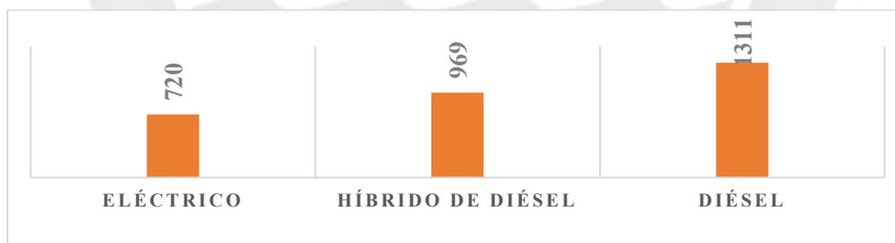
**Figura 47:** Comparación de emisiones de bus eléctrico, híbrido de diésel y diésel de 12m en gr de fCO<sub>2</sub>/km (Adaptado de *Grütter, 2015*)
