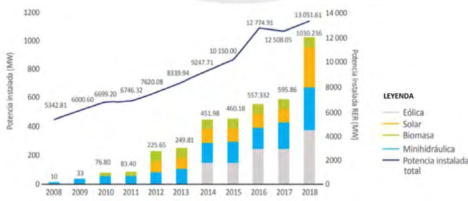
Figura 5: Evolución de la potencia instalada de las centrales RER (Adaptado de Osinermin, 2019)
