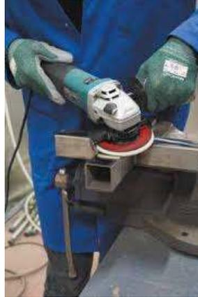
Figura 37: Uso de EPPS indicados en corte
