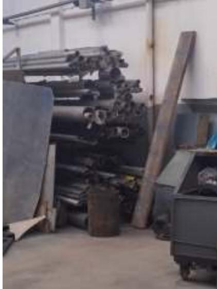
Figura 20: Cargas o apilamientos inseguros
