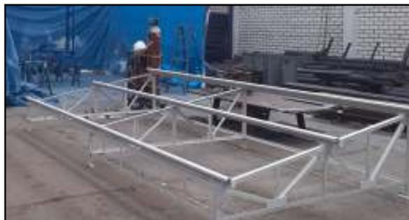
Figura 11: Estructura para equipo Osmosis Inversa, después de arenar
