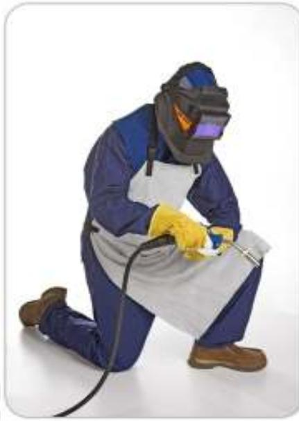
Figura 36: Soldador debidamente equipado
