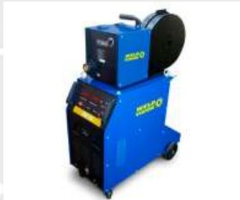
Figura 14: Máquina de soldar MIG 400 A
