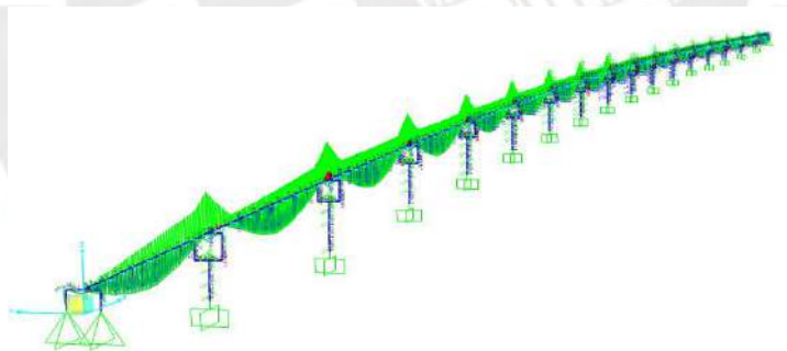
Fig 51. Ley de Momentos Flectores. Tren de Cargas Ferroviarias
