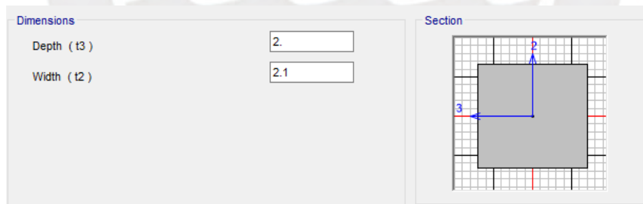
Fig 23. Dimensiones de la Sección Pila 1
