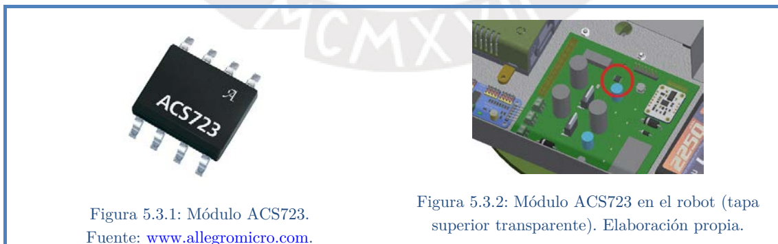
Figura 5.3: Sensor de corriente basado en efecto Hall ACS723.
