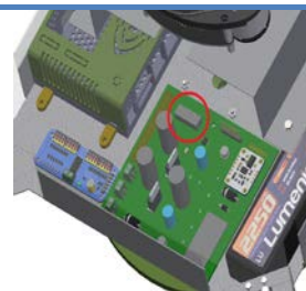
Figura 5.4.2: Módulo MCP3004 en el robot.
