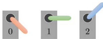
Figura 6.3: Posiciones angulares permitidas para los servomotores. Elaboración propia.
