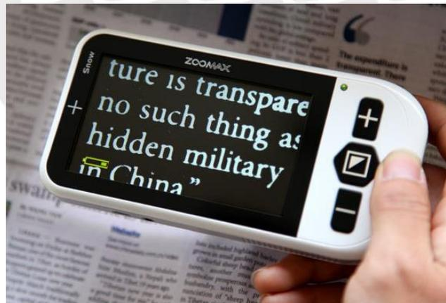
**Figura 1.5:** Lupa electrónica Zoomax [13].
