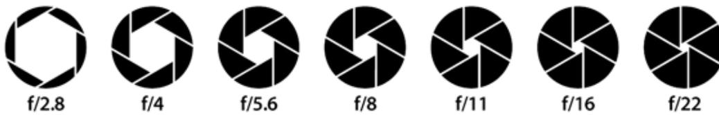
**Figura 2.6:** Apertura del iris de la cámara. Un valor más elevado de f indica menos cantidad de luz ingresando al sensor [26].
