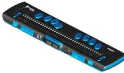
**Figura 1.3:** Línea Braille de la marca Focus Blue [12].
