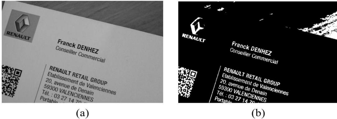
**Figura 2.14:** Binarización de un documento mediante umbralización adaptiva [35].
