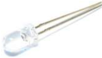
Figura N°32. Diodo led alta luminosidad Fuente propia
