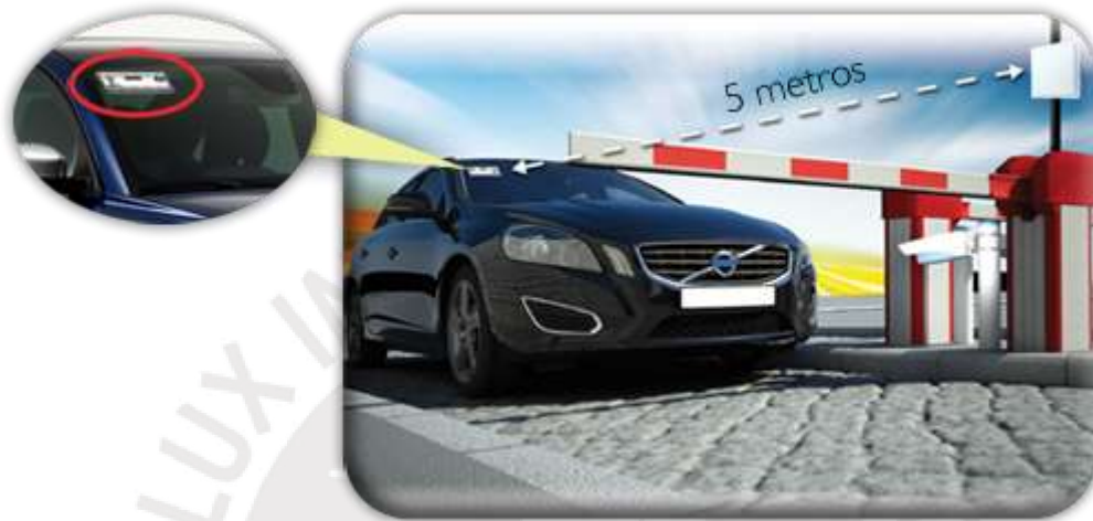
Figura 1. Identificación de la pegatina o sticker electromagnético por el transductor
