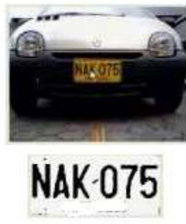
Figura 43. Procesamiento de placa de autos aplicando los filtros
