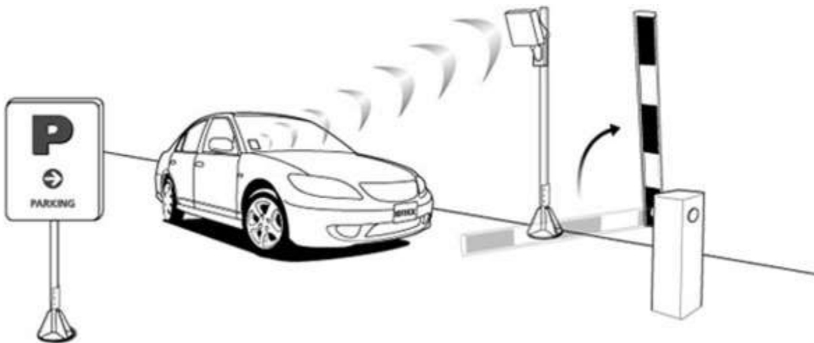
Figura 4. Ingreso vehicular aplicando tecnología RFID implantada en el automóvil
