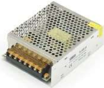
Figura 39. Fuente para etapa de potencia
