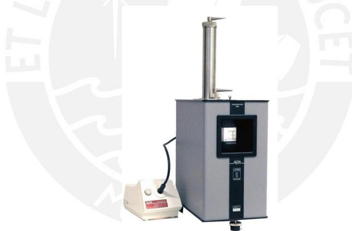
Figura 3.3 Micromanómetro de Betz.
