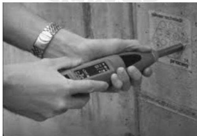
Imagen 2.3 Ensayo del número de rebote en concreto (Helal et al, 2015)
