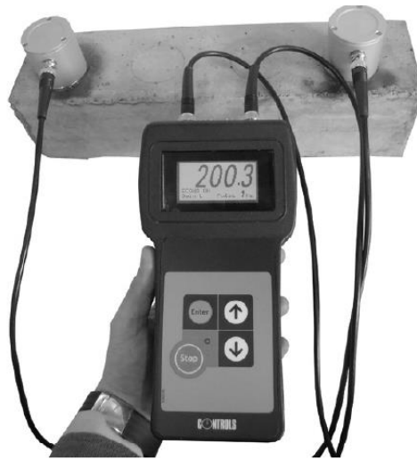
Imagen 2.2 Ensayo de velocidad de pulso de ultrasonido. (Helal et al, 2015)
