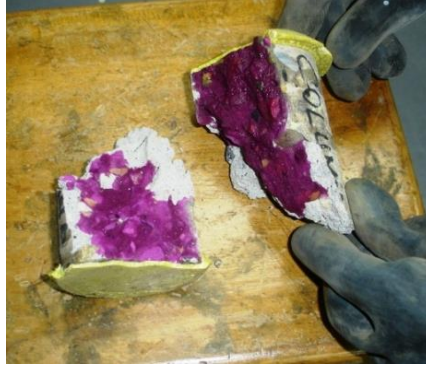
Imagen 2.5 Prueba de carbonatación en un núcleo de concreto (Tomado de: https://www.360enconcreto.com/blog/detalle/carbonatacion-del-concreto-como-detectarla )
